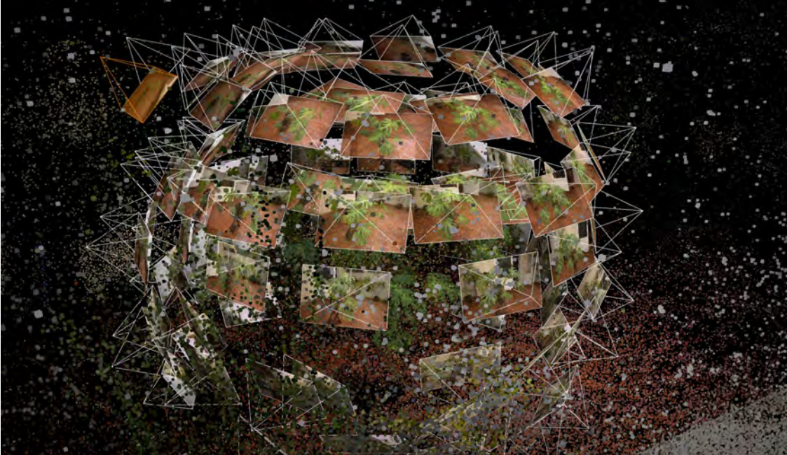
Figura 6 - Structure from motion- Mecanismo que observa pontos de interseção na imagem e posiciona em um espaço tridimensional, criando uma nuvem de pontos e o mapeamento dos pontos de vista na extração de colmap.
